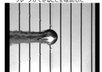
飛翔試験で撮像した衝突体 2km/s以上の飛翔速度を確認した
