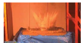
衝突体の砂への打ち込み実験 クレータができることを確認した
