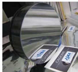
コールドスプレー法で試作したCFRP鏡
