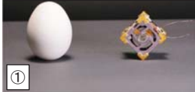
超小型三軸姿勢制御モジュール（卵とのサイズ比較）
