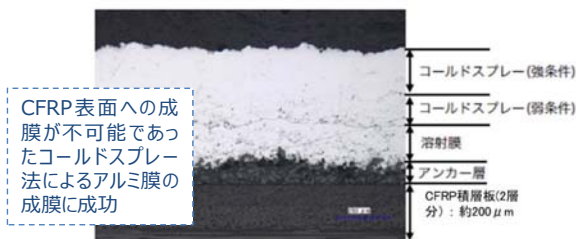
コールドスプレー法により成膜したアルミ層の断面
