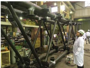
アンテナ主鏡パネルを支える骨組みの 工場での仮組の状況
