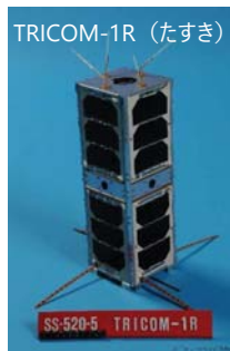
サイズ：116mm×116mm×346mm（アンテナ部除く） 重量：約3.2kg
