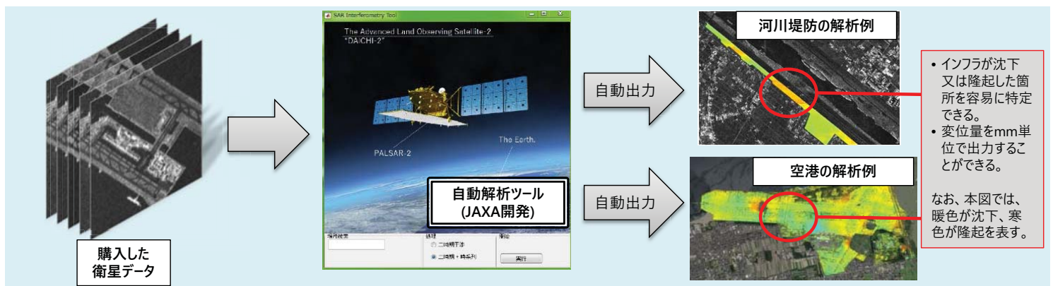
図1：自動解析ツールを用いたインフラ変位解析のイメージ
