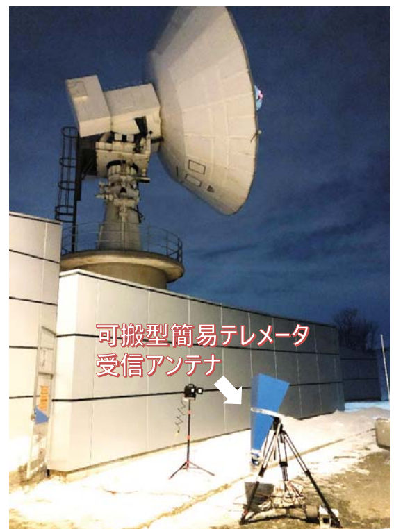
可搬型簡易テレメータ局の構成 （研究試作）
