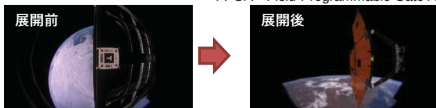
TMSAP展開の様子（JAXAコーディネイト開発のカメラ・NB-FPGAを利用）
