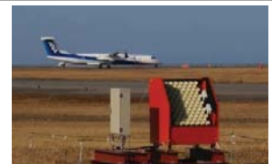
地方空港向けの低コスト低層風情報提供システム（SOLWIN）
